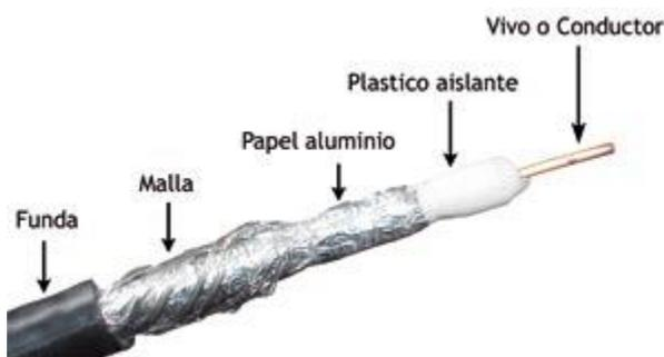
No se usa para audio de baja frecuencia, es decir, para conectar equipos como el CD, la computadora... Su misión es llevar las señales de alta frecuencia desde el transmisor a la antena. Los hay de varios tamaños y grosores dependiendo de la potencia que manejemos. Los coaxiales son muy usados para conectar antenas de TV y servicios de televisión por cable. Pero recuerda que el coaxial de video tiene una impedancia de  $75 \Omega$ , mientras que el
