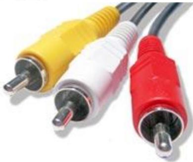
Muy usado en los equipos domésticos de audio para conectar el DVD a la TV, o el CD al componente... Suele ir siempre en pareja ya que se emplea para transportar señales estéreo.
